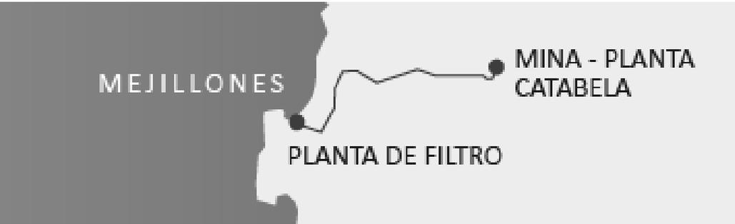
La construcción del Acueducto Mejillones - Sierra Gorda (140 Km y 36 pulgadas de diámetro) es un aporte importante para el medio ambiente, al recuperar agua de descarte del enfriamiento de turbinas eléctricas.
